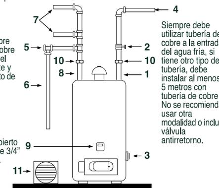
Siempre debe utilizar tubería de cobre a la entrada del agua fría, si tiene otro tipo de tubería, debe instalar al menos 5 metros con tubería de cobre. No se recomienda usar otra modalidad o incluir válvula antirretorno.
