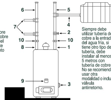
Siempre debe utilizar tubería de cobre a la entrada del agua fría, si tiene otro tipo de tubería, debe instalar al menos 5 metros con tubería de cobre. No se recomienda usar otra modalidad o incluir válvula antirretorno.
